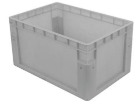
6430立体库箱A款防静电 外尺寸：600*400*300mm 内尺寸：544*362*286mm 重量：2.9kg
