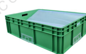
EU8622箱 外尺寸: 800*600*220mm 内尺寸: 760*565*209mm 重量: 3.80kg
