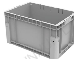
6435立体库箱 外尺寸：600*400*350mm 内尺寸：544*362*336mm 重量：3.29kg
